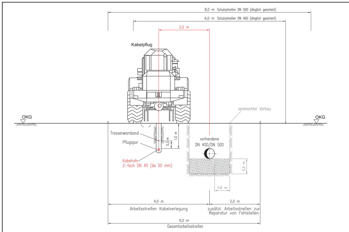
**Abbildung 4-2: Arbeitsstreifen für Kabelverlegung parallel zur vorhandenen FGL 012**
