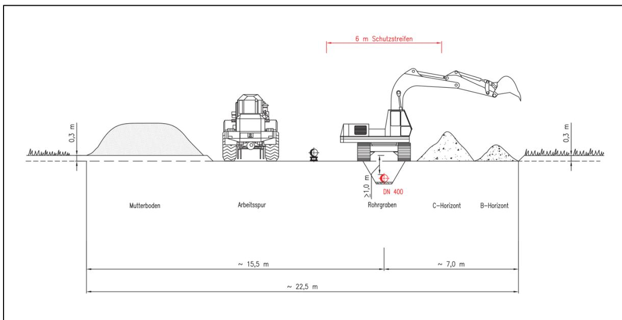
**Abbildung 4-1: Regelarbeitsstreifen DN 400 im Offenland**
