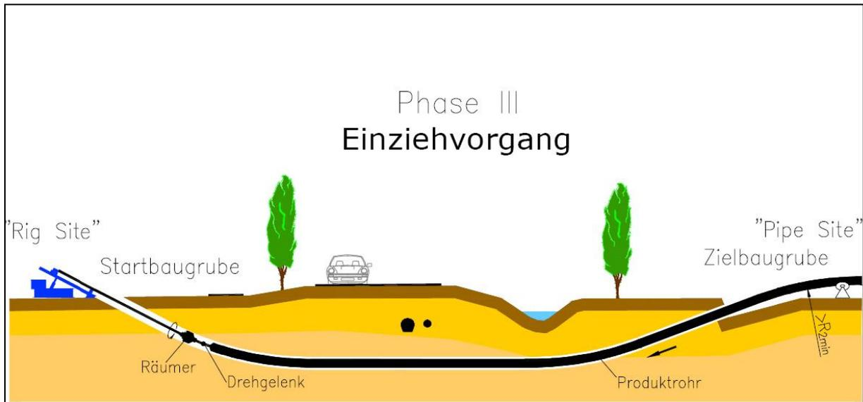
**Abbildung 4-3: HDD-Verfahren Phase III – Einziehvorgang**
