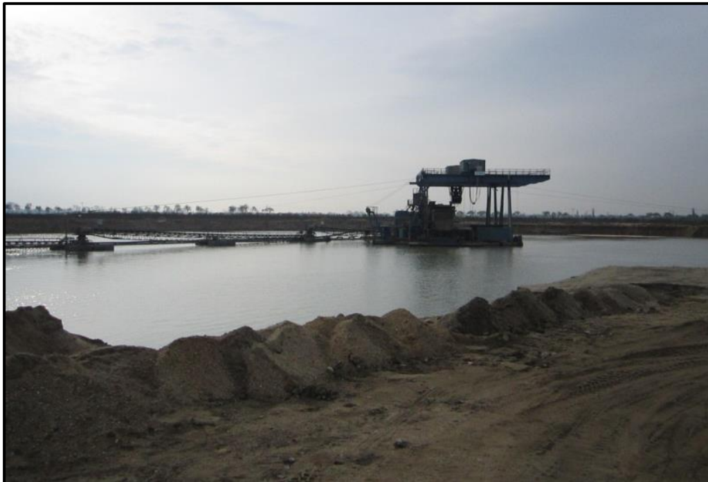
Abbildung 3: Geplante Gewinnungstechnologie - Nassbagger mit Schwimmbandanlage
