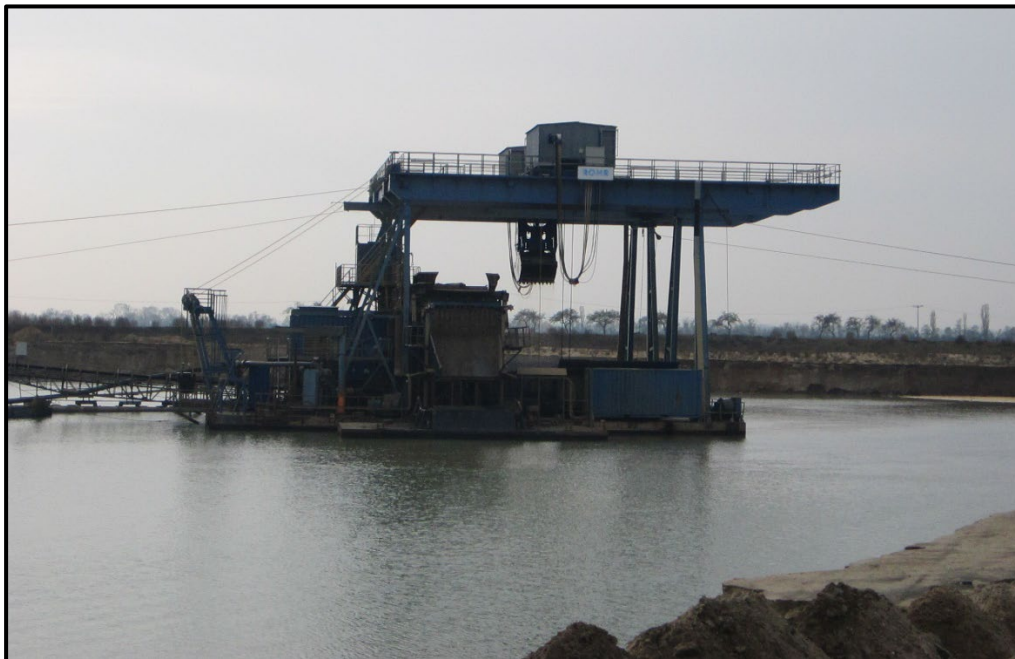
Abbildung 6: Geplantes Gewinnungsgerät RS 2x8,0/280 Bf (Fa. ROHR)
