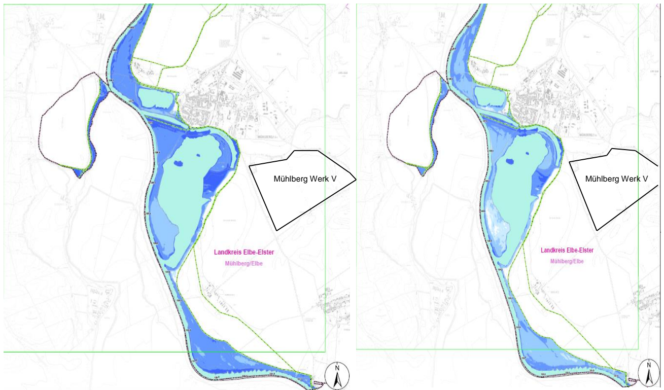
Abbildung 8: Überschwemmungsflächen nach Hochwassergefahrenkarte, Stand 05.02.2016 bei einem mittleren (HQ 10, rechtes Bild) und einem hohen (HQ 100) Hochwasser (linkes Bild)
