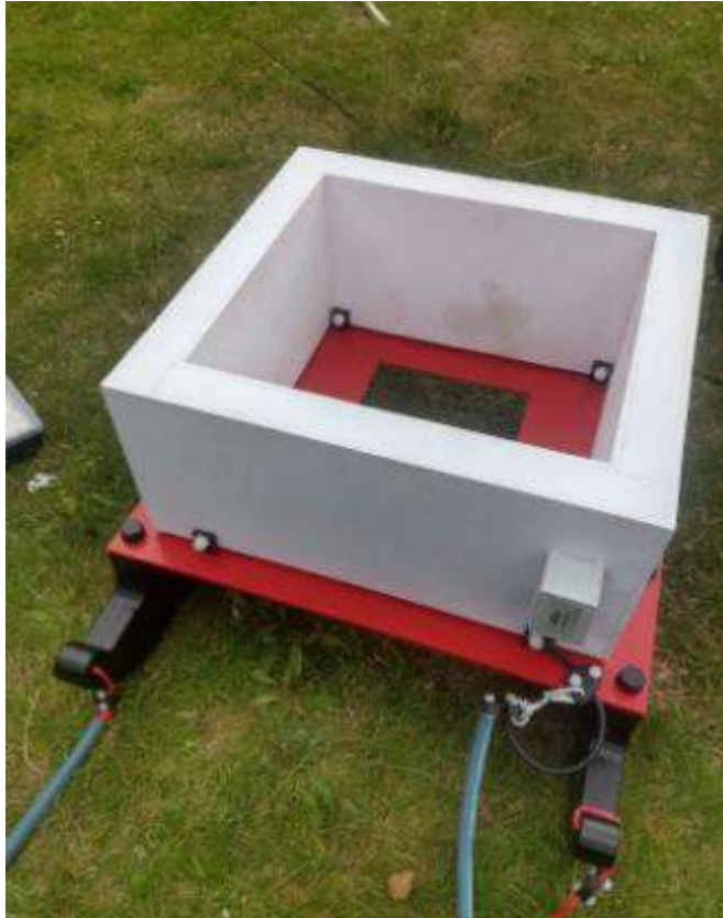
Bild A1-5: Um bewegungsinduziertes Rauschen zu reduzieren, wird die TEM-Empfängerspule eingehängt.
