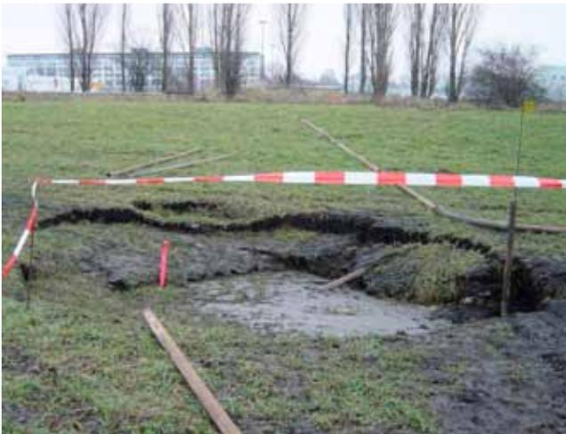
Abb. 183: Treibschacht „Körner III“ vom 04. Dezember 2002, Durchmesser: 5 m, Tiefe: 1 m (Foto: T. GÖBEL)
