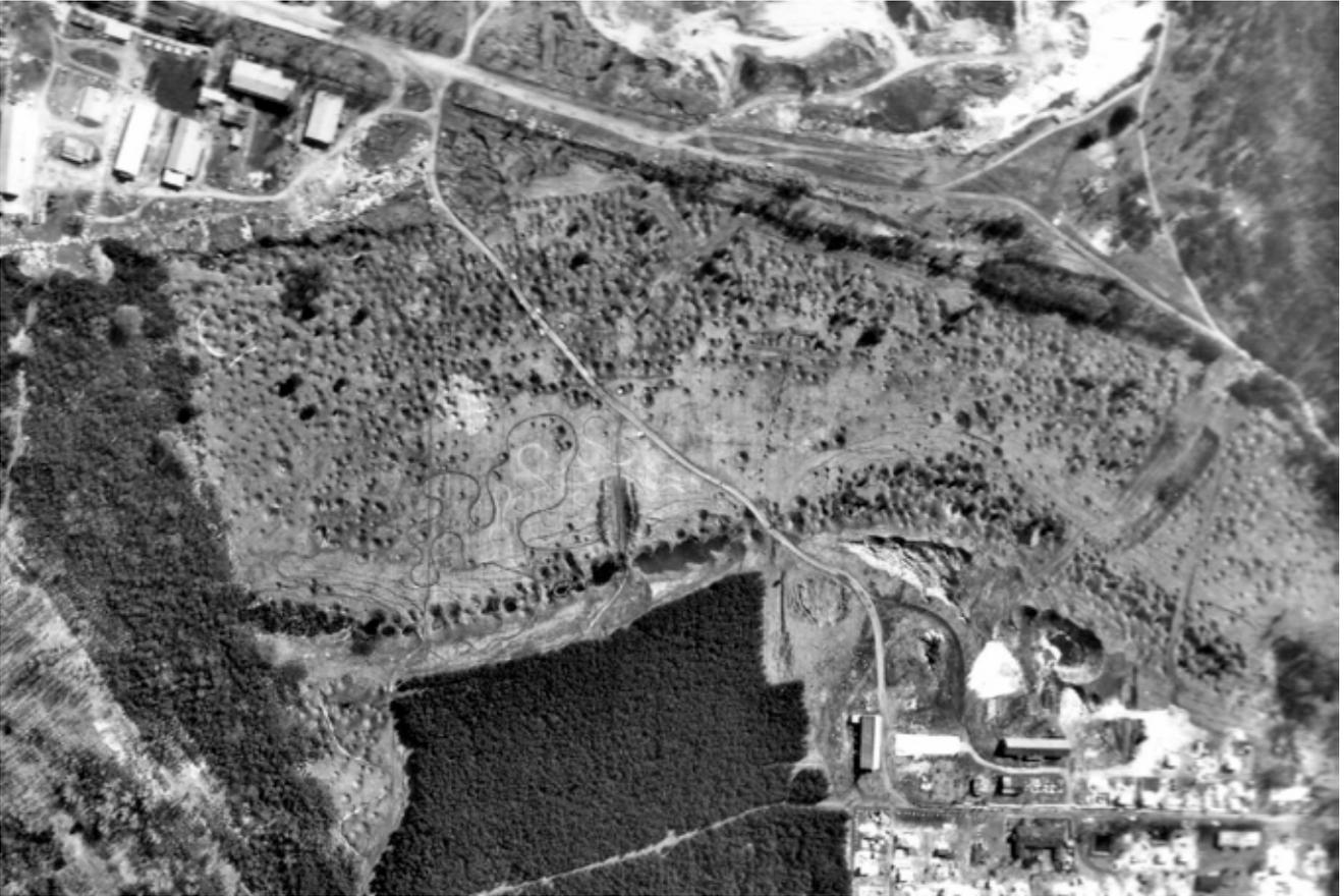
Abb. 179: Luftaufnahme des Bruchfelds über dem ehemaligen Braunkohlentiefbau „Margarethe“, westlich Brieskow-Finkenheerd – Hunderte von Bruchtrichtern mit Durchmessern bis zu 12 m prägen die etwa 16 ha große Graslandschaft (Bildarchiv R.-G. WEDDE).
