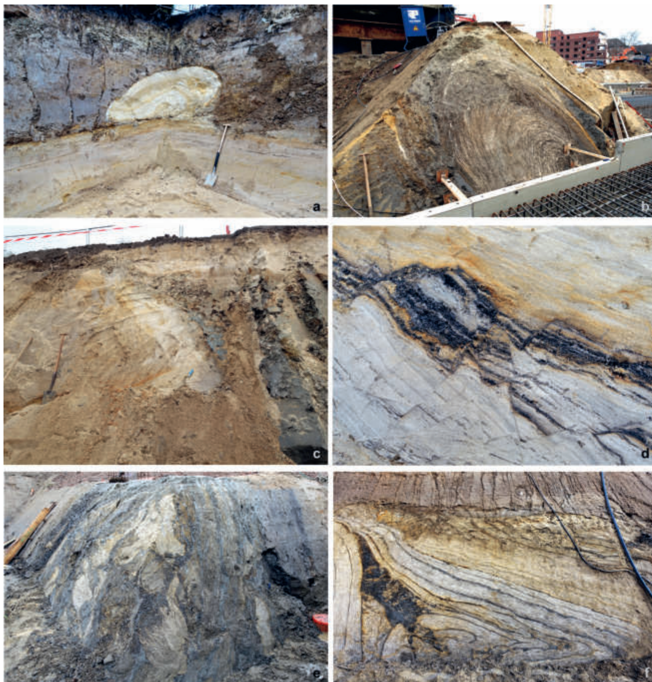
Abb. 1: Verschiedene Formen glazitektonischer Deformation in Hamburg: a – Sand-Scholle an der Sohle einer Schuppe von (Lauenburger?) Ton in Hummelsbüttel; b – Falte in Beckensedimenten in Hamm; c – ruptuelle Deformation/Schuppenbildung mit Lauenburger Ton in Hummelsbüttel; d – kleinskalige spröde Deformation mit braunkohleführenden Schmelzwassersanden in Eidelstedt (Ausschnitt ca. 0,4 m); e – Schollen- und Schuppenbildungen in feinkörnigen Ablagerungen in Hamm (Höhe der Wand 1,6 m); f – plastische und ruptuelle Deformation in Barmbek (Ausschnitt ca. 3 m)
