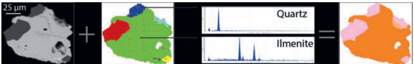
Abb. 3: Automatisierter Charakterisierungsprozess der MLA: Das BSE-Bild wird basierend auf den EDX-Spektren klassifiziert und über eine definierte Mineralliste prozessiert.
