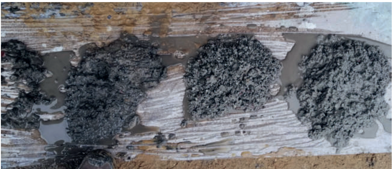
Abb. 4: Vier Proben der Bohrung Es Wredenhagen 1/2023 zwischen 87 und 102 m mit Fokus auf Probe 93–96m (3. Haufen von rechts). Die Pollenanalyse ergab zwischen 93–96m nachgefallenes Material von brackisch-marinem Holstein der PZ 5a mit einer marinen Diatomeenflora.
