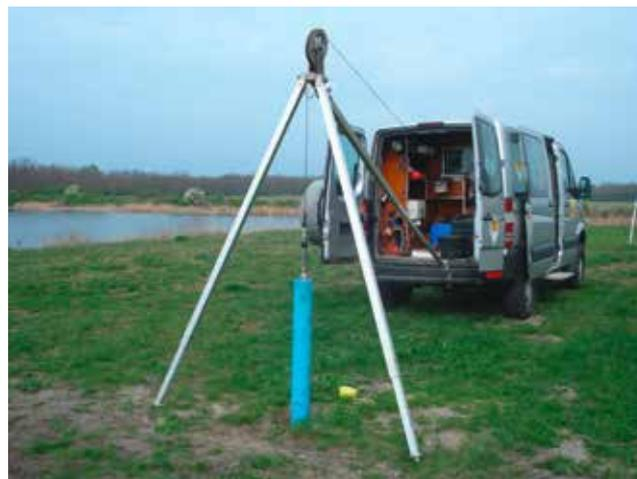
Abb. 3: Messfahrzeug mit in eine Grundwassermessstelle einfahrendem Induktions-Log
