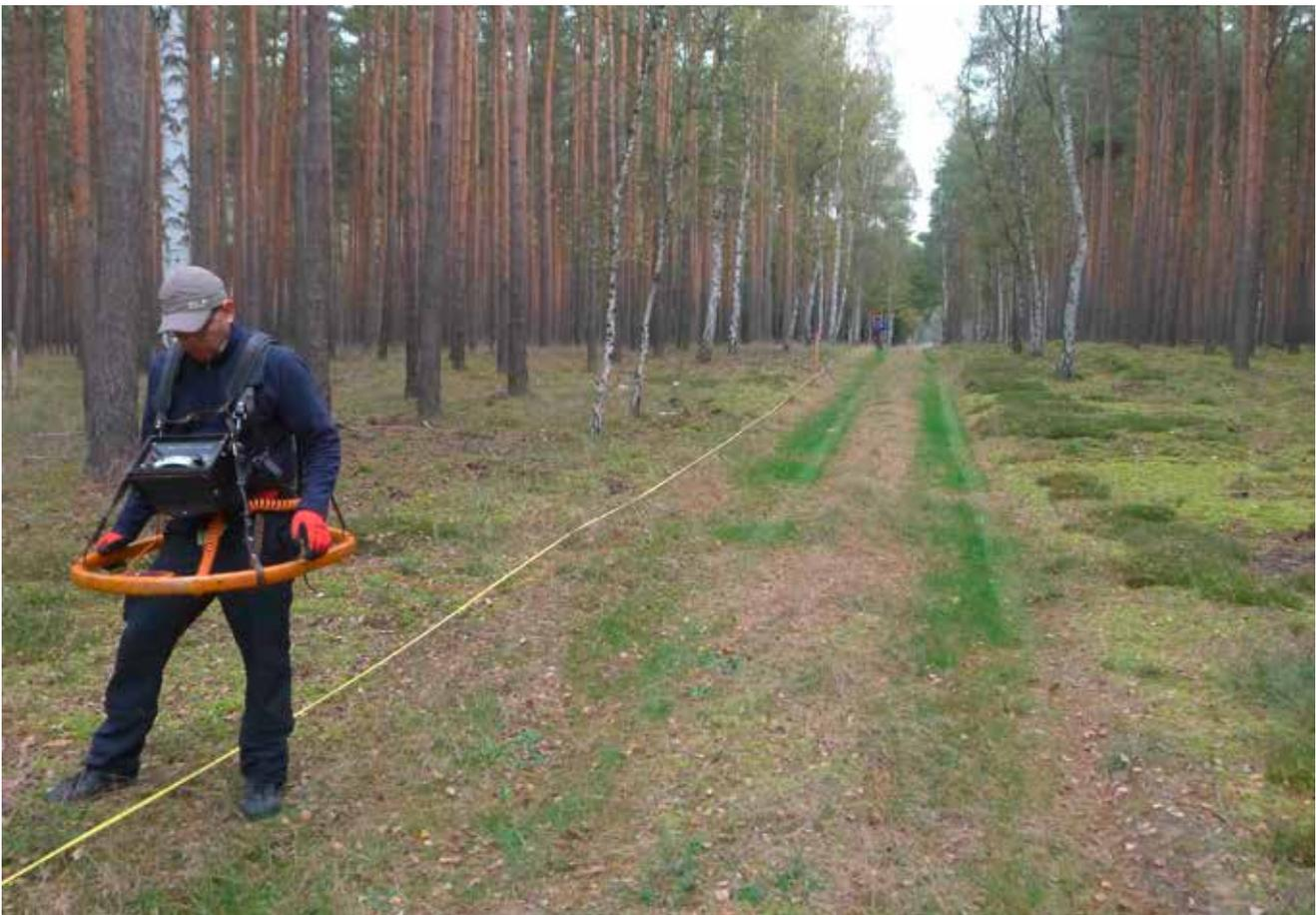
Abb. 5: EM-Messung mit 100 m Separation auf Profil 3 (EM-Sender im Vordergrund)
