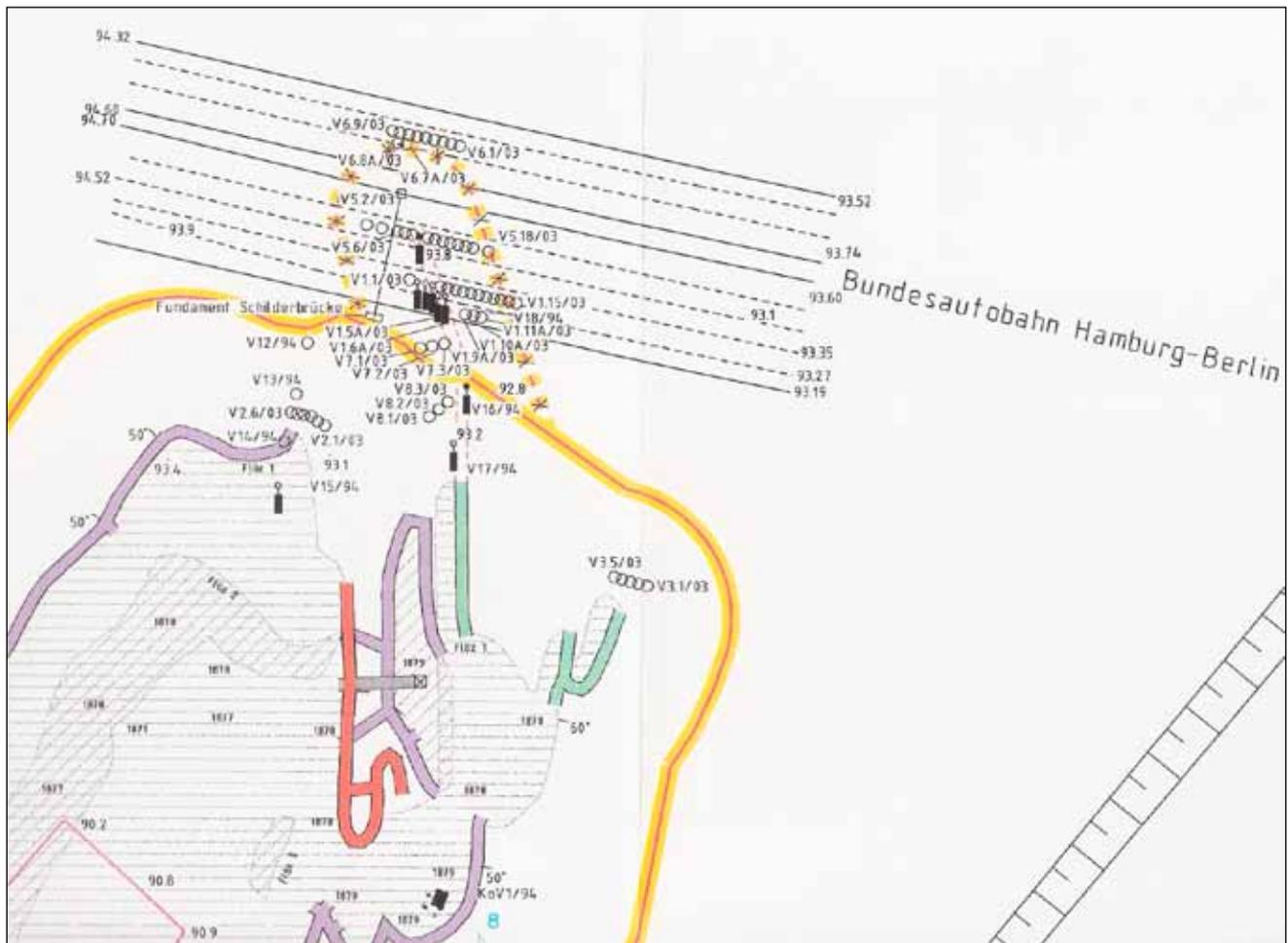
Abb. 31: Betriebsriss der Verwahrdokumentation Braunkohlenbergwerke bei Papenbruch – Gefährdungsbereich GB I [entnommen: BERGSICHERUNG UND BAUGRUNDSANIERUNG GMBH FRANKFURT (ODER) 2003]
