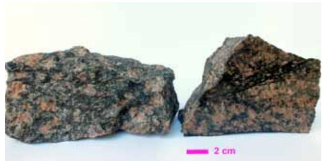
Abb. 8: Probe vom Askersund-Granit neben einem angeschliffenen Spaltrest vom Neuendorfer Amt Stein.
