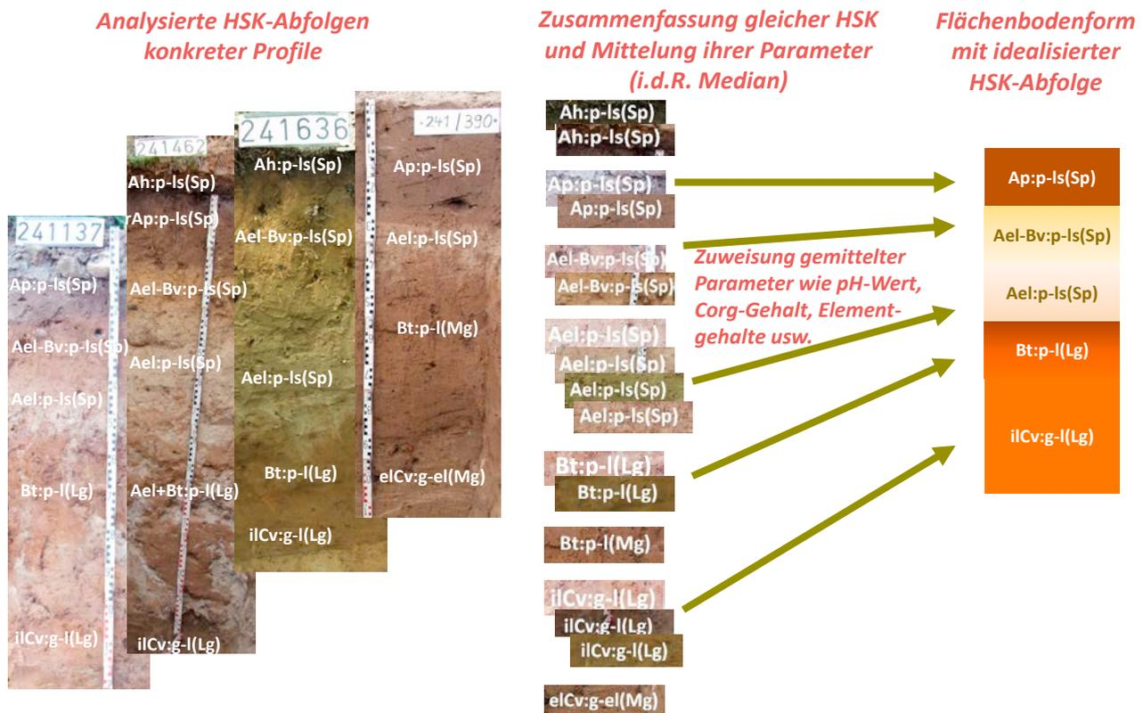
Abb. 18: Prinzip der Idealisierung von HSK-Abfolgen zu einer FBF mit Parameterzuweisung am Beispiel einer LF-BB: p-s(Sp)/p-l(Lg) (Kurzzeichen, siehe Auswahl Register bzw. KA 5)
