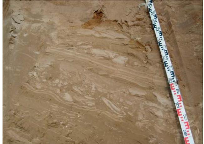
Abb. 5: Feinsandige Schluffe im Liegenden des weichselzeitlichen Tills. Der Till setzt oberhalb der Marke 25 ein. Zu sehen sind synsedimentäre Deformationen (Entwässerungsmarken) der Schluffe; dazwischen immer wieder weitgehend ungestörte Abschnitte. Wriezen-Biesdorf (R: 3438071, H: 5840423)
