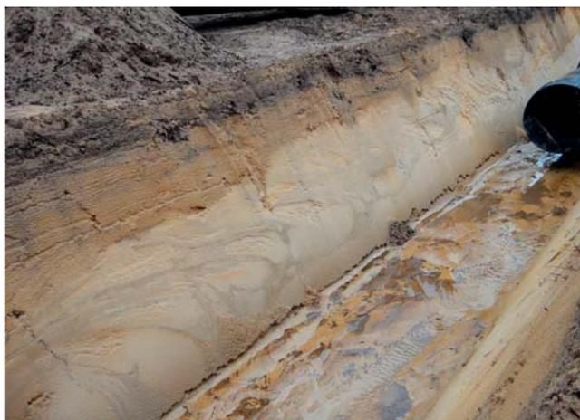
Abb. 13: Gestauchte und in Eisbewegungsrichtung (Süden = links) gestreckte glazilimnische Feinsande und Schluffe nördlich von Luckau-Rüdingsdorf (R: 3408496, H: 5750049)
