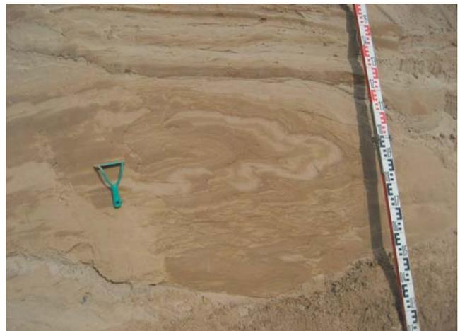
Abb. 6: Feinsandige Schluffe im Liegenden des weichselzeitlichen Tills (ab Marke 19). Außer den synsedimentären Deformationen wurden die Stauwassersedimente hier noch glazitektonisch gefaltet. Wriezen-Biesdorf (R: 3438043, H: 5840517)
