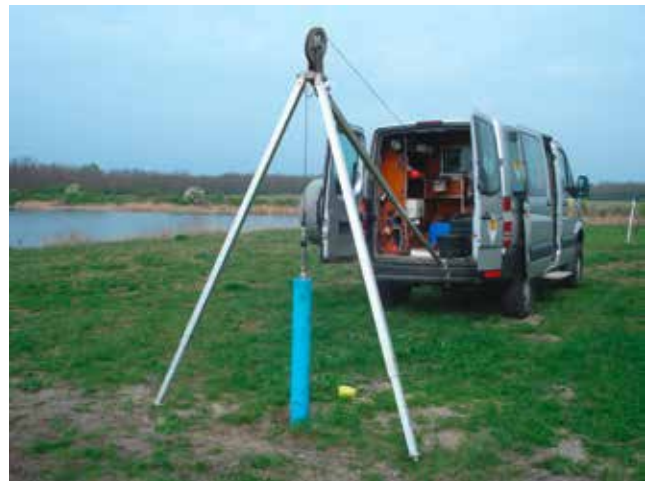
Abb. 3: Messfahrzeug mit in eine Grundwassermessstelle einfahrendem Induktions-Log
