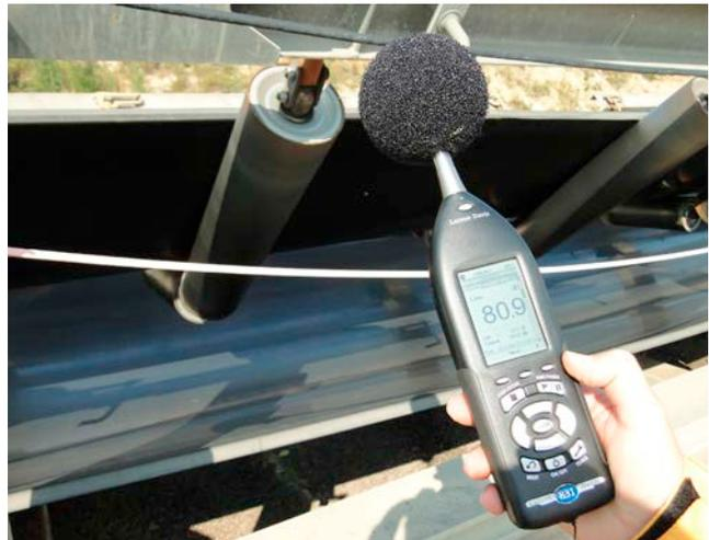
Abb. 8: Geräuschmessung an einer Bandanlage (Foto: LBGR 2014)
