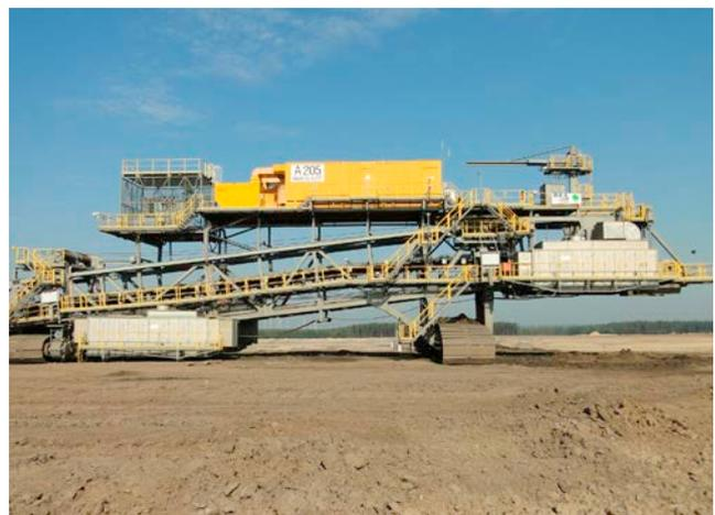
Abb. 7: Antriebsstation mit gekapselten Antrieben (Foto: LBGR 2014)
