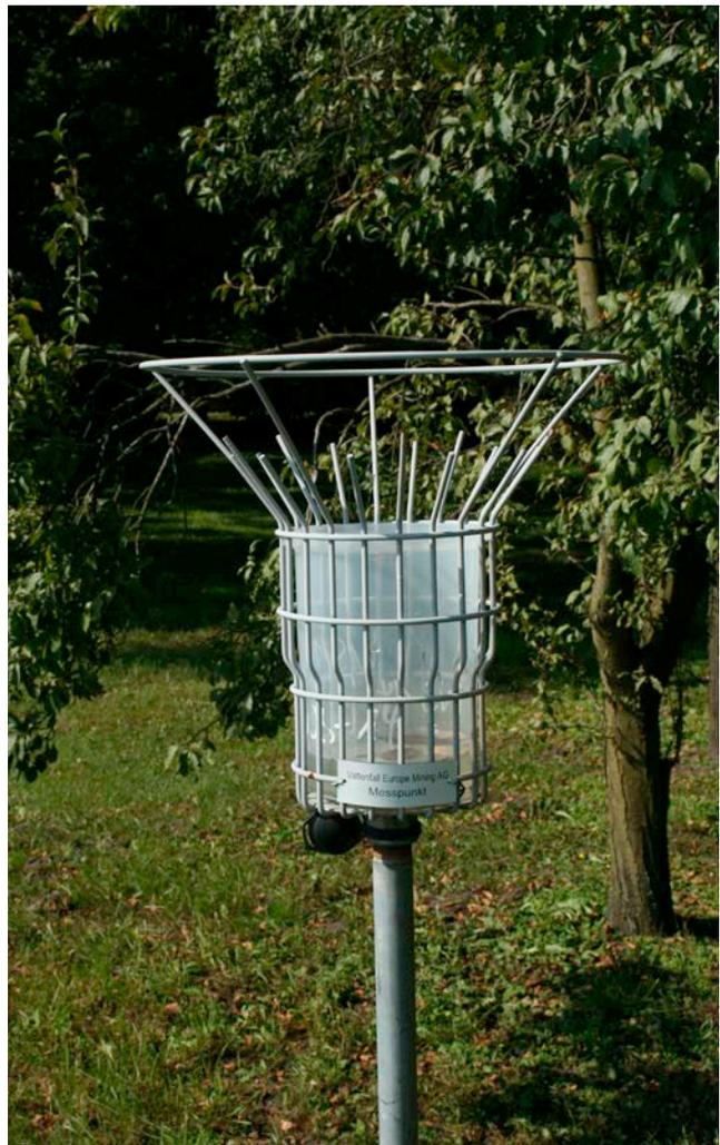
Abb. 9: Staubbiederschlagsmessung mittels Bergerhoff-Gerät (Foto: LBGR 2014)
