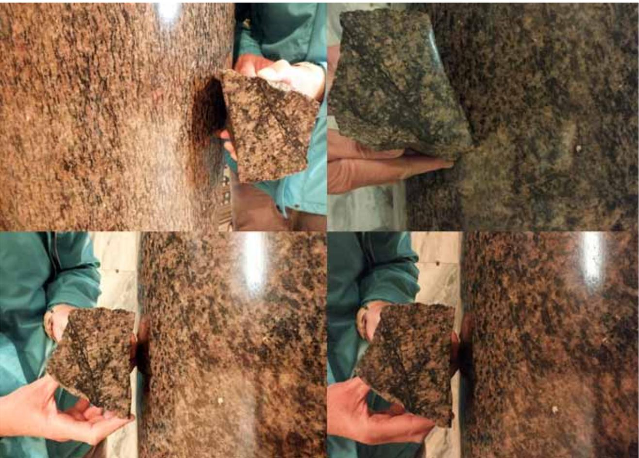
Abb. 7: Vergleich einer angeschliffenen Probe vom Großen Stein/Amt Stein bei Neuendorf mit einer Säule im Aachener Dom.
