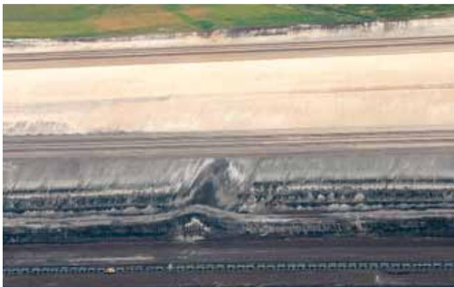
Abb. 1: Einzelne Sattelstruktur in der Faltenzone Heinersbrück: Diskordante Überlagerung der Deformationen (Grundwasserleiter G410 und 2. MFK) durch weichselzeitliche Schmelzwassersande im Glogow-Baruther Urstromtal (Foto: VE-M, 2002)
