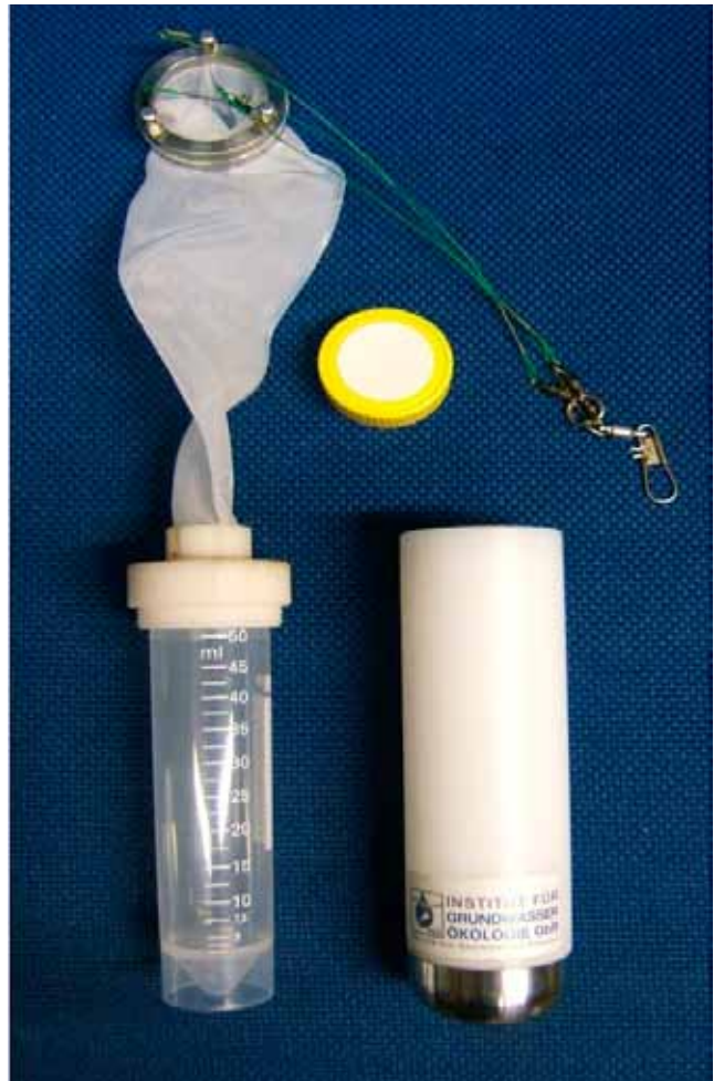
Abb. 2: Der Netzsammler ist ein schnelles und zuverlässiges Werkzeug, um Grundwassertiere in Messstellen zu fangen. (Foto: C. SPENGLER, 2012)
