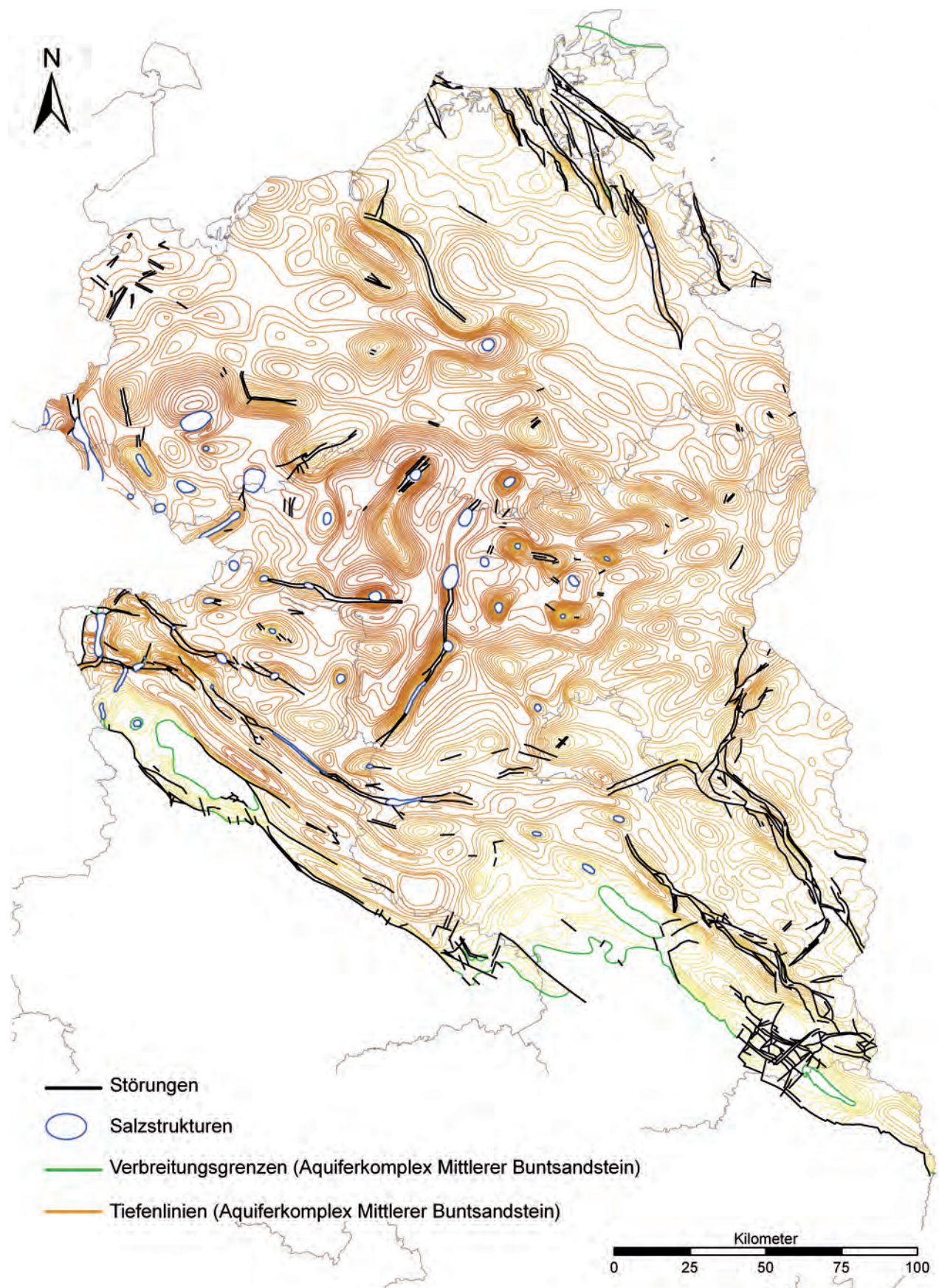
Abb. 3 Vollständige Isobathenkarte für die Basis des Aquiferkomplexes Mittlerer Buntsandstein in NE-Deutschland Fig. 3 Complete isobathic map for the base of the Middle Buntsandstein aquifer complex of NE Germany
