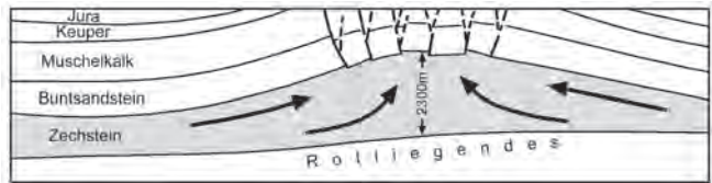
Abb. 2 Schematische Skizze der Grabenbildung über einer Salzkissen während des Salzaufstieges (GGD/GLA 1997)
