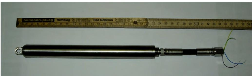
Abb. 6 Prototyp einer miniaturisierten Sonde für die Vermessung von Erdwärmesonden
