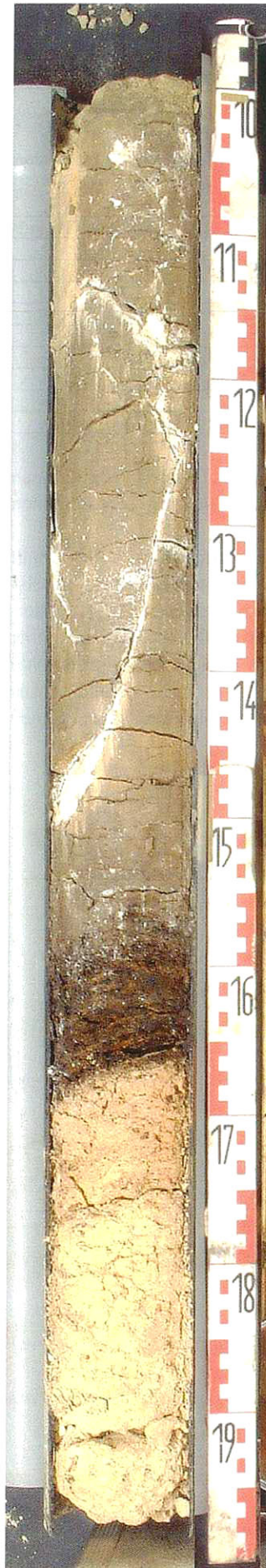
Abb. 2 Kern 2 (1-2 m Teufe) der KB Röpersdorf 1/00: geklüftete Ton- mudde über Torf, dar- unter mit deutlicher Grenze Kalkmudde
