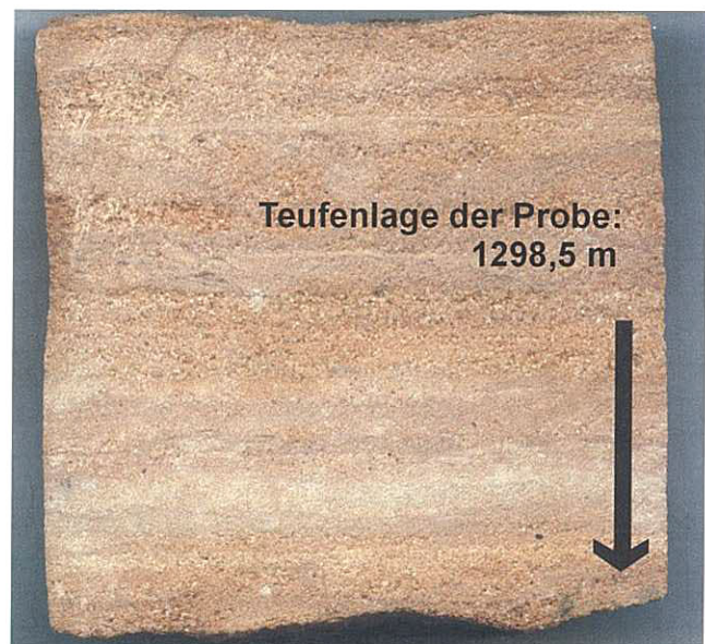
Abb. 7a Volpriehausen-Sandstein-Probe, rotbrauner Gesteinstyp Fig. 7a Volpriehausen sandstone specimen, auburn rock type
