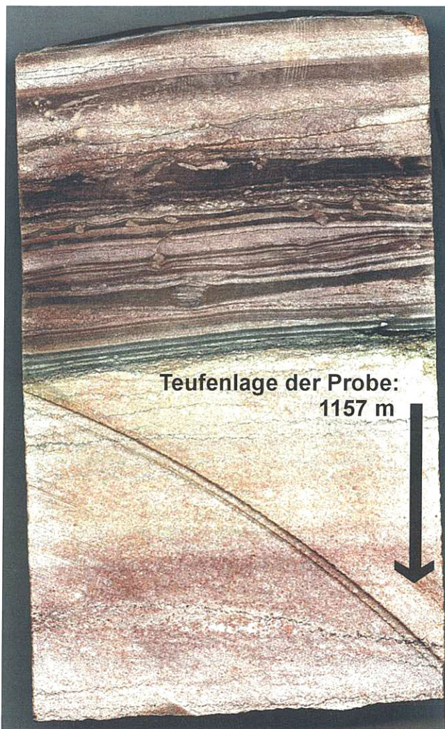
Abb. 6 Typische Detfurth-Sandstein-Probe mit Entwässerungsstrukturen in den tonig-schluffigen Lagen des oberen Bereichs Fig. 6 Typical Detfurth sandstone specimen with dehydration structures in the clayey to silty layers of the upper section
