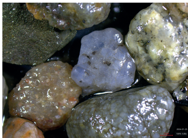
Abb. 1: Kleingeschiebe 4-10 mm unter dem Binokular. Im Bildzentrum ist ein nordischer Quarz mit sehr starker Blaufärbung zu erkennen (Foto: O. Juschus 2025).
