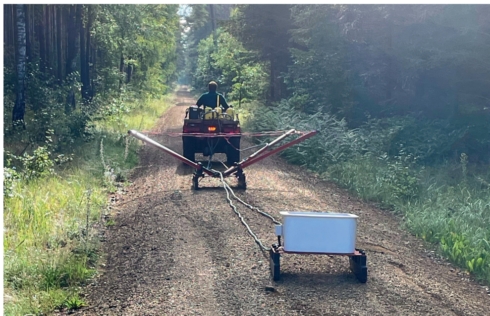
Abb. 3: Feldarbeit bei der Untersuchung mittels tTEM-Verfahren
