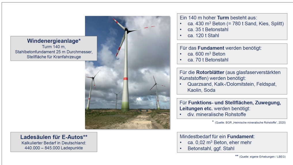
Abb. 2: Beispiele für den durchschnittlichen Rohstoffbedarf für Bauwerke im Rahmen der Energiewende
