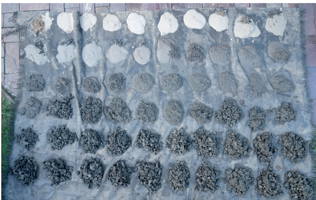
Abb. 1: Beispiel einer Auslage von Spülbohrproben im 4 m-Intervall einer vom LBEG aufgenommenen Bohrung (Foto: A. Engeler)
