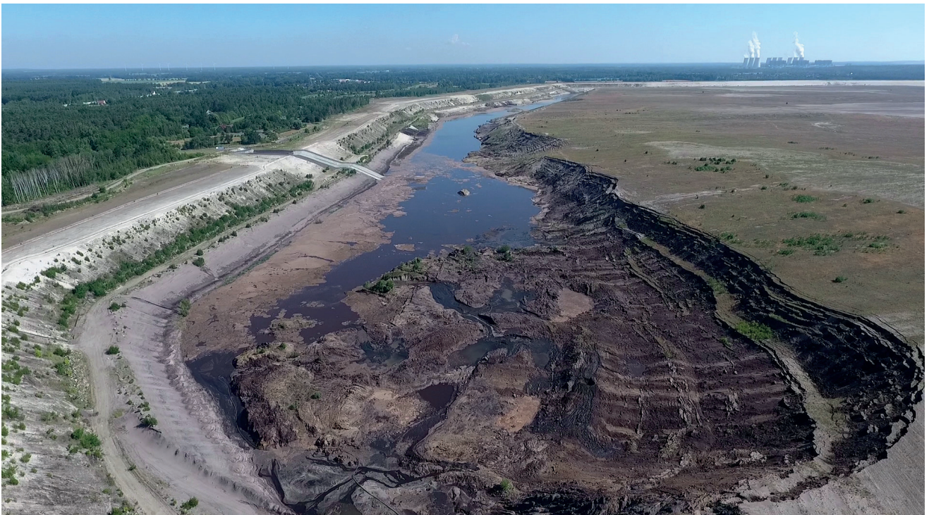
Abb. 1: Erwartetes Setzungsfließen am 19.06.2019 während der Flutung des Cottbuser Ostsees innerhalb des geotechnischen Sperrbereiches (Foto: LE-B, Markscheiderei)
