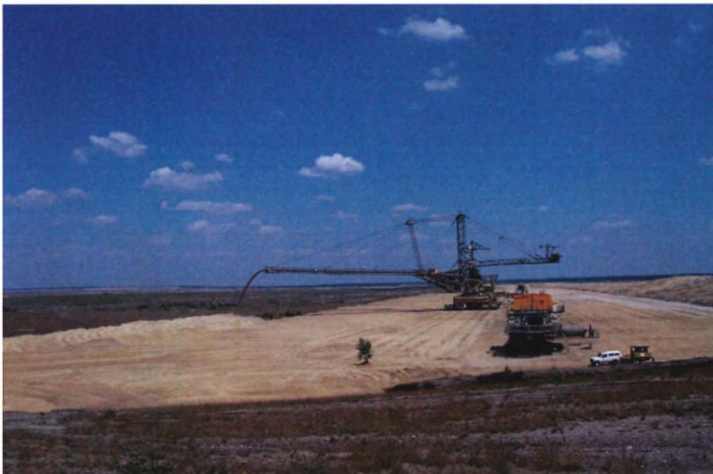
Foto 8. Ein Absetzer überdeckt die aus lebensfeindlichem, tertiärem Boden bestehende Brückenkippe (im Bild links hinten) mit pleistozänem Boden und schafft so die nährstoffarme Absetzerrohkippe. – Foto: R. Möckel (Tagebau Jänschwalde)
