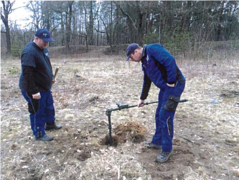
*Der Sondengänger bei einer Kontrollmessung nach händischer Aufgrabung*
