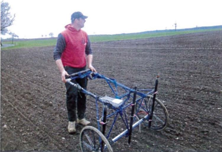
Die Suchfelder werden in Aufnahmespuren Nord-/Südrichtung verlaufend mit einem Abstand von ca. 1,50 m bis 2,50 m zueinander eingeteilt und die Spuren mittels Farbspray und amagnetischen Fluchtstangen markiert.
