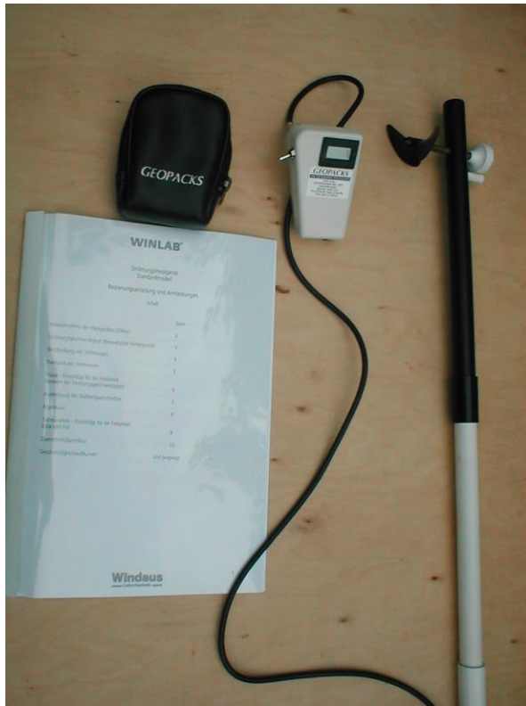
Abbildung 8: Messgerät zur Fließgeschwindigkeitsmessung: Flowmeter GEOPACKS der Fa. WIKLAB®
