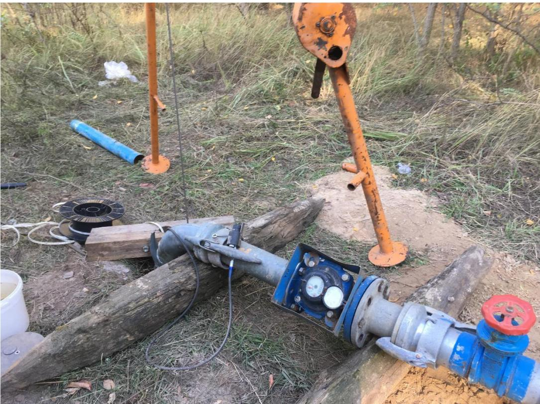
**Abbildung 8: GWM 1/18 mit Leitung und Wasserzähler**
