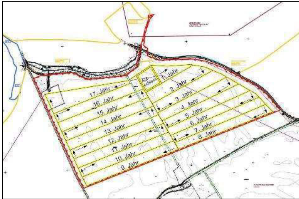
Abb. 2: Schematisches Abbaukonzept (aus G.E.O.S. 2020a)
