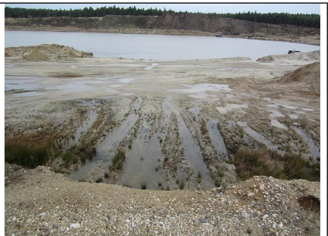
**Foto 21 (05.12.2013):** Zeitweise wassererfüllte Fahrspuren entstehen im laufenden Betrieb und „wandern“ mit dem Trockenabbau mit – Blick nach N/NW zum Nordwall
