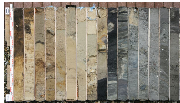
Kernaufnahme an einer Bohrung
