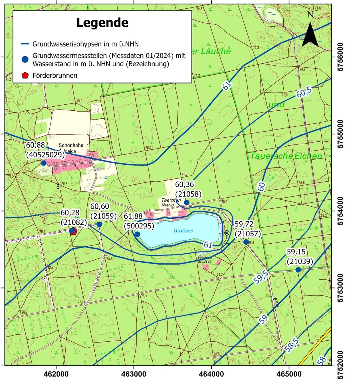
**Abb. 5** – Grundwasserisohypsenplan des Untersuchungsgebietes (Daten: LE-B 2024, Stichtagsmessung: 17.01.- 19.01.2024, Einleitmenge 1.896 m<sup>3</sup>/d) – Kartengrundlage: Geobasisdaten: DTK25, ©GeoBasis-DE/LGB 2014
