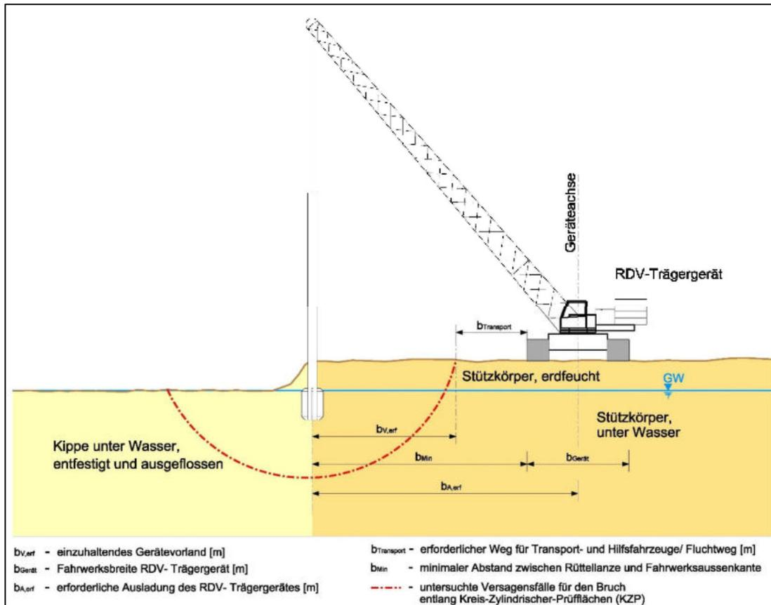
Abbildung 4-1: Prinzipskizze der RDV-Technologie
