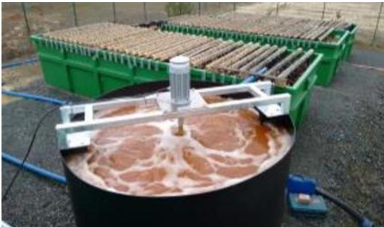
**Bild 14:** Blick auf die Pilotanlage zur Schwertmannitfällung an der GWBA Tzschelln, Quelle: GEOS (2020).
