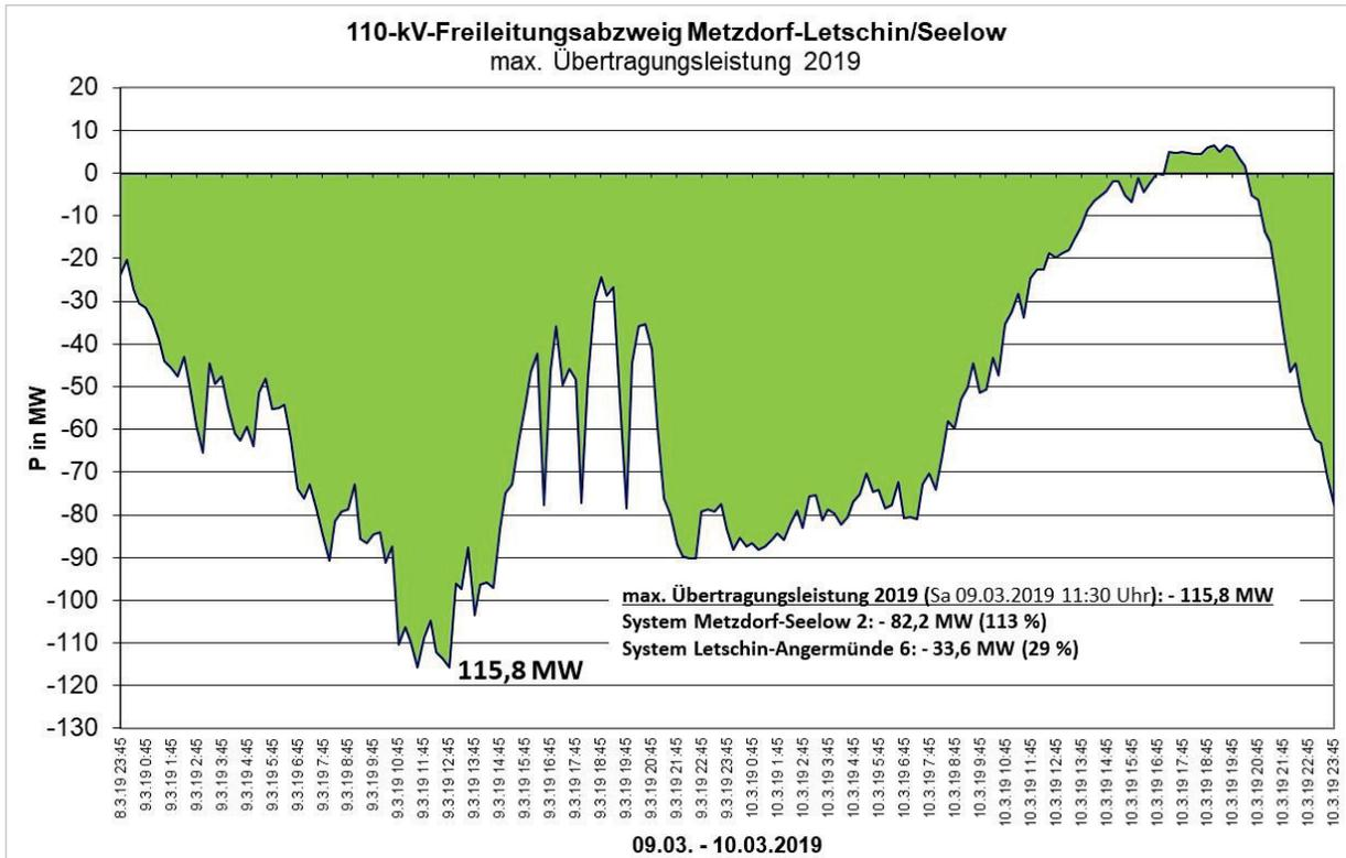
**Abb. 5 – Übertragungsleistung (2019) 110-kV-Leitungsabschnitt Letschin - Seelow**
