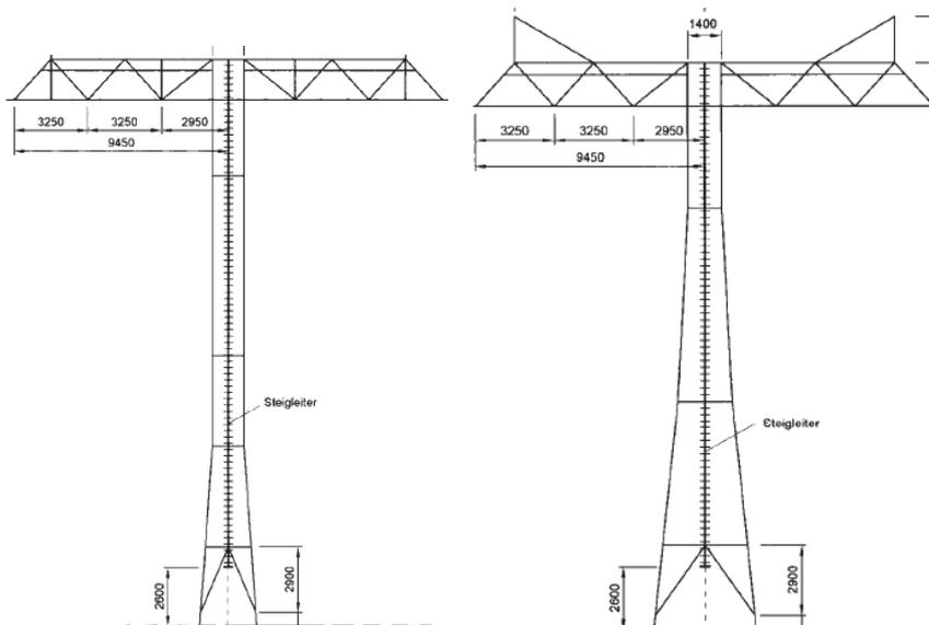
Abb. 16 – Tragmast, Abspannmast
