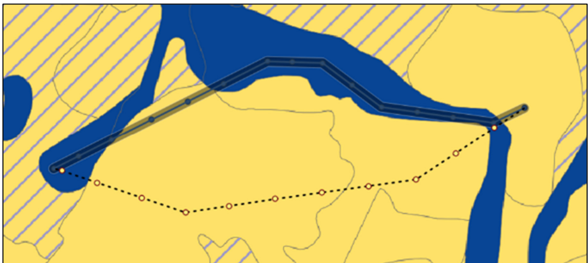
Abbildung 11: Vernässungsverhältnisse im Bereich der Bestandsleitung und des geplanten Trassenabschnittes der 380-kV-Freileitung Preilack-Streumen inkl. Schutzstreifen (grau, 100 m breit)
