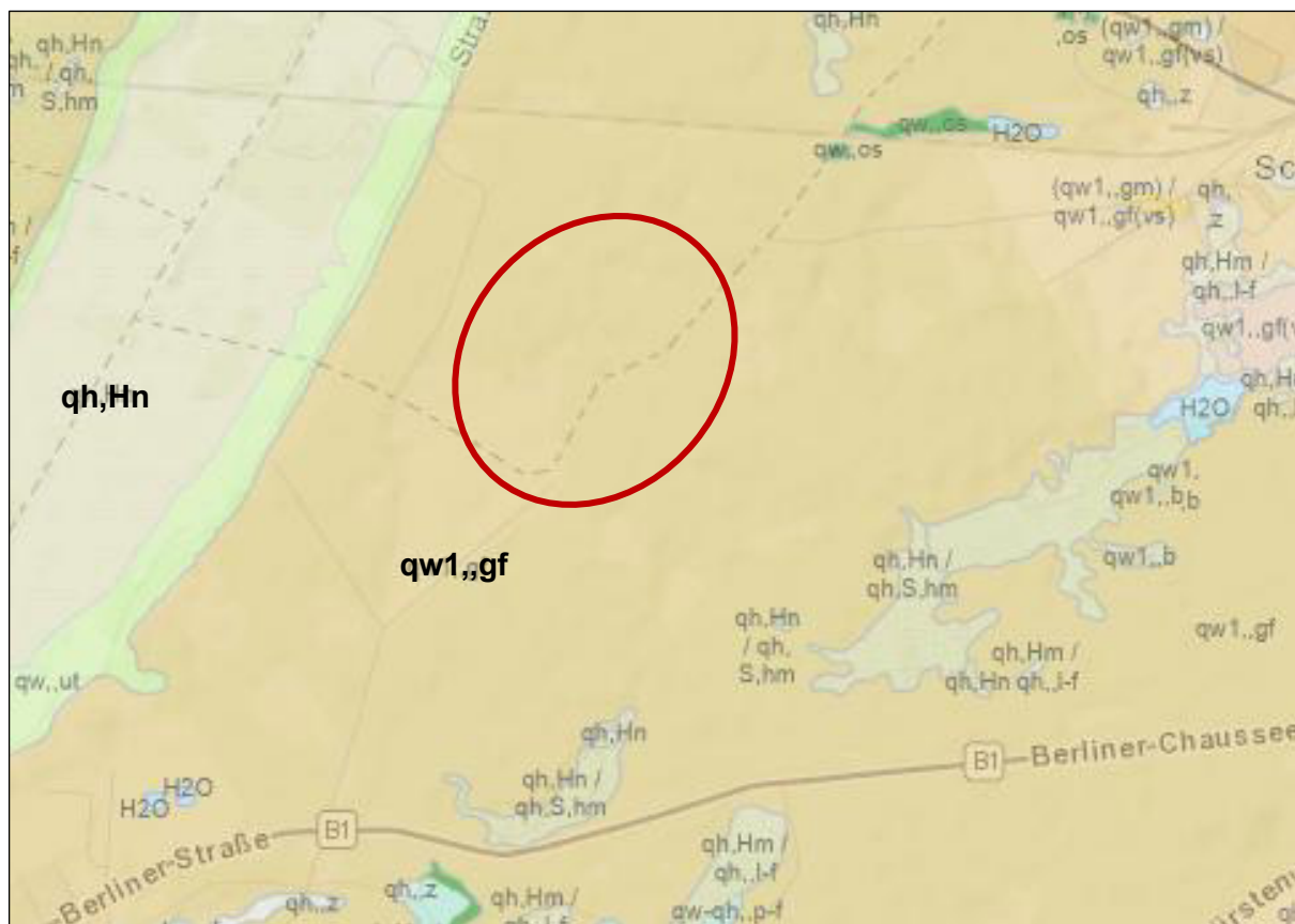
Abbildung 4: Verbreitungsgrenzen geologischer Einheiten an der Geländeoberfläche im Tagebau Müncheberg-Vorheide II einschließlich seiner Erweiterungsfläche, nach Geologischer Karte 1: 25.000 /5/
