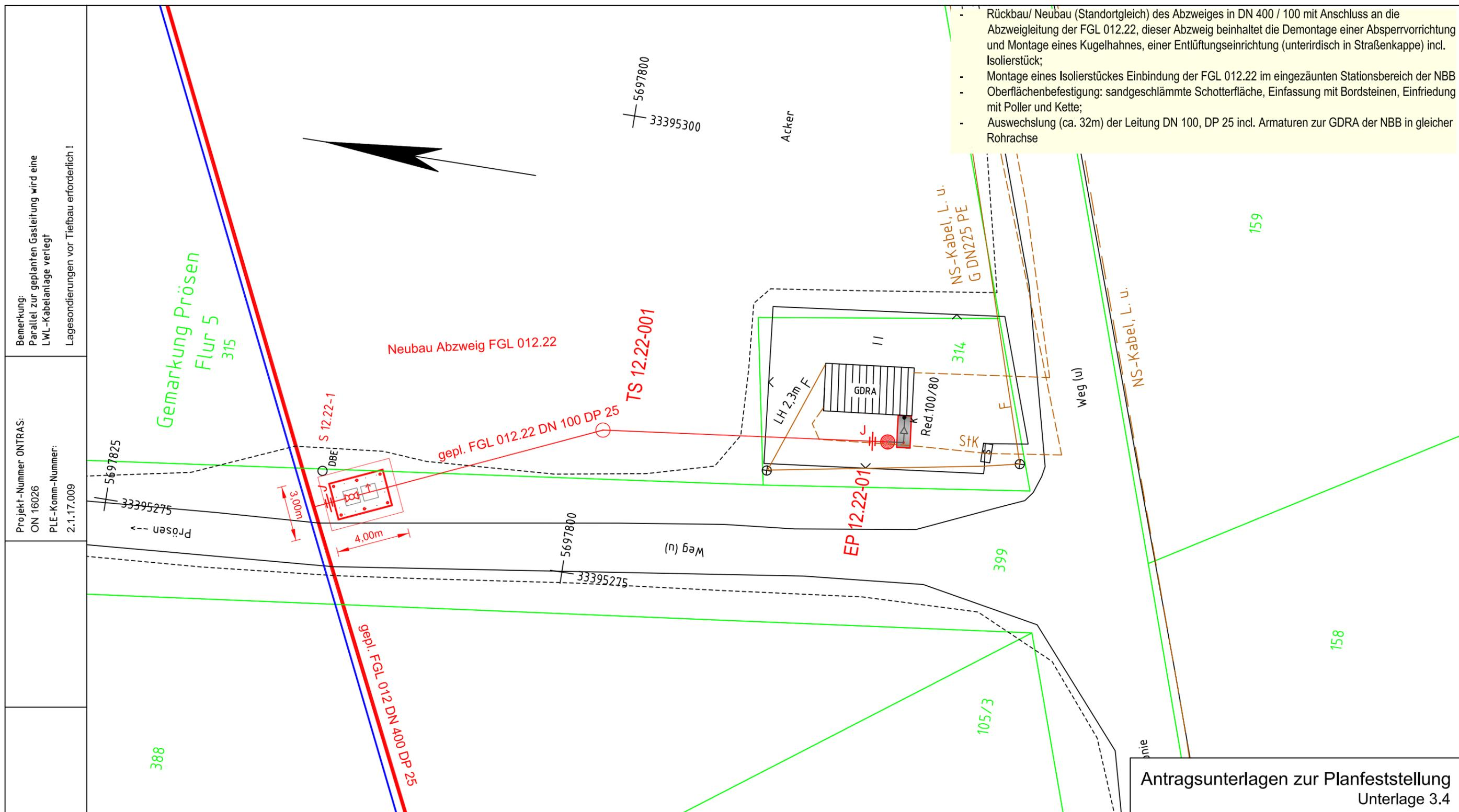
Rückbau/ Neubau (Standortgleich) des Abzweiges in DN 400 / 100 mit Anschluss an die Abzweigung der FGL 012.22, dieser Abzweig beinhaltet die Demontage einer Absperrvorrichtung und Montage eines Kugelhahnes, einer Entlüftungseinrichtung (unterirdisch in Straßenkappe) incl. Isolierstück;
