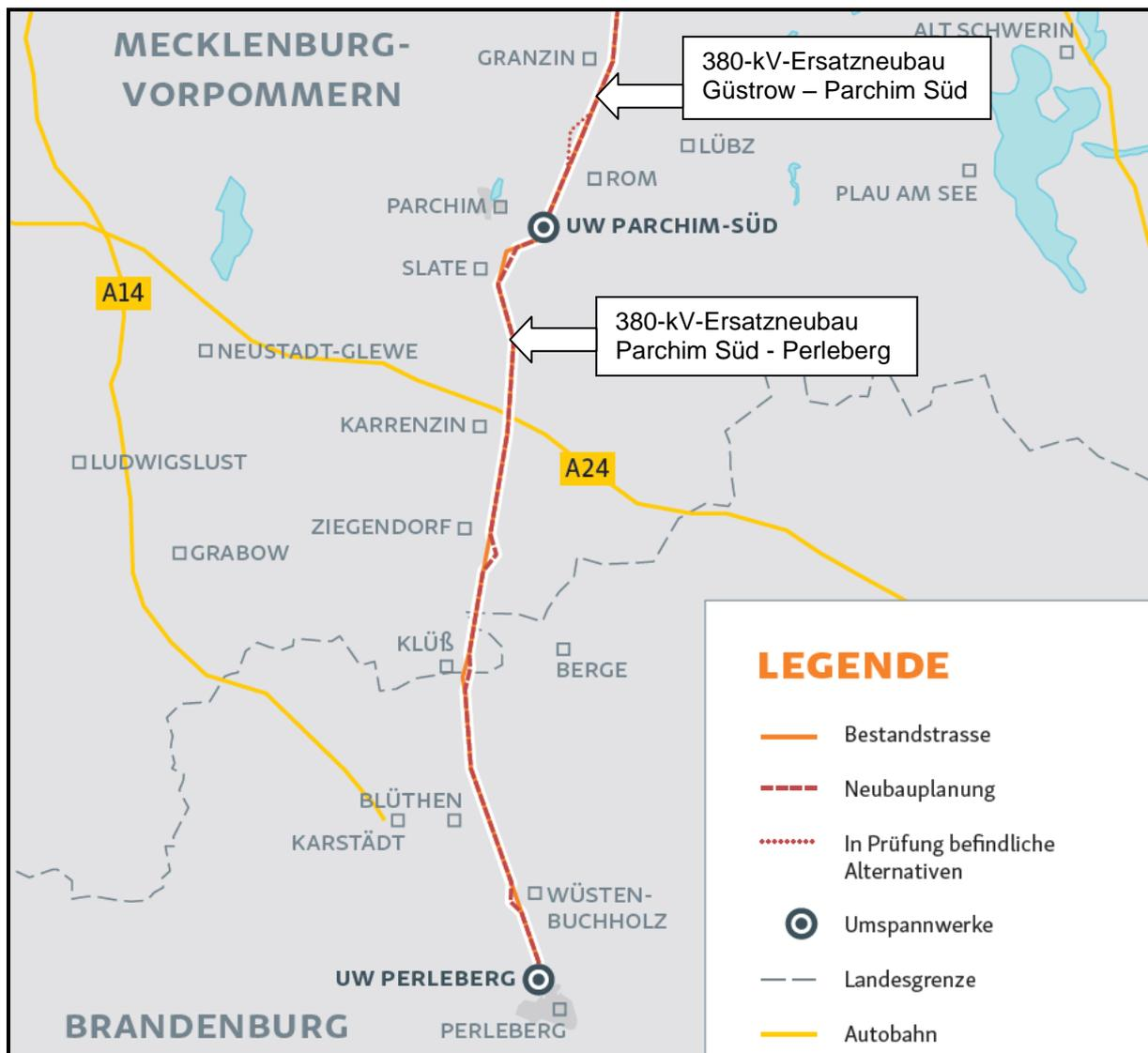
Abbildung 3: Übersicht Bestandstrasse und 380-kV-Ersatzneubau (Quelle: 50Hertz)
