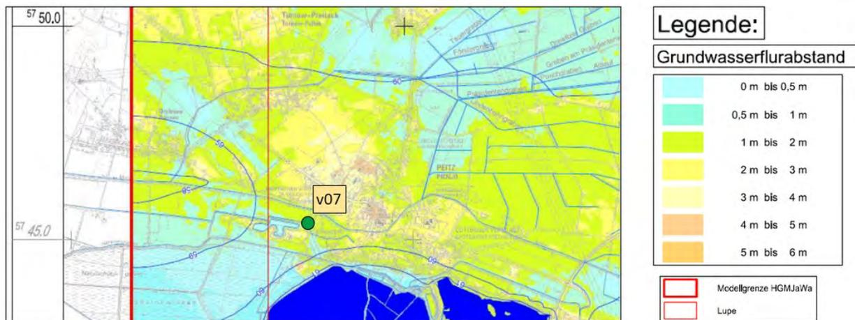
Abbildung 27: Grundwassergleichen und Grundwasserflurabstände zum Zeitpunkt 12/2018 ((IBGW, 2018, z.B. Anlage 3.2) und Lage des virtuellen Pegels V07
